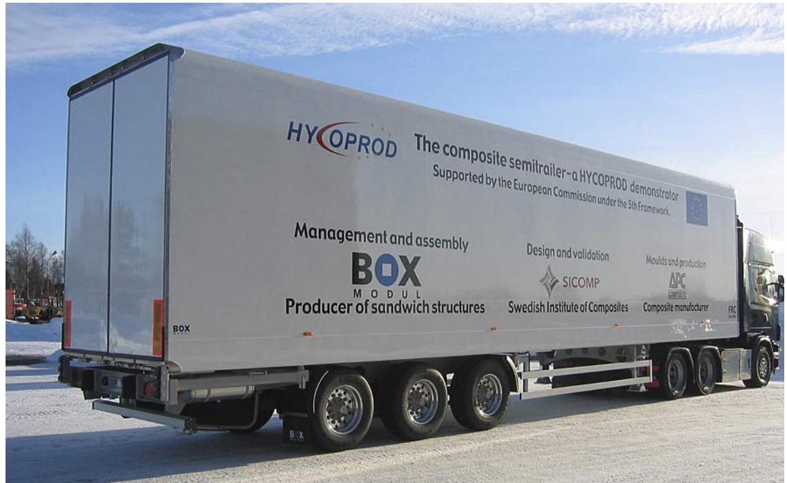
Komposittrailer utvecklad av Box Modul i samarbete med APC Composit och SICOMP.
