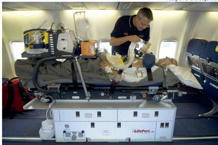
Intensivvårdsbåren monterad i en Boeing 737-800 under räddningsövning.
